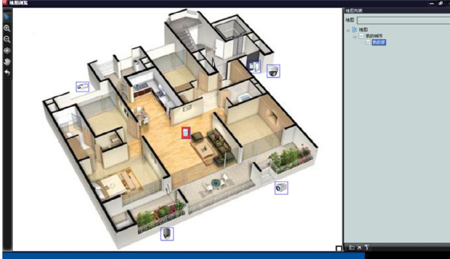
系统提供虚拟矩阵实现模拟矩阵类似功能，在各监控中心及监控室内可按已分配的资源及控制权限，设置本中心视频输入信号、解码器及 PC 工作站输出及录象，实现视频实时控制及监控、回放、事件回放、按规则的视频轮询及报警管理等功能。视频轮询功能不仅能在大屏幕上执行，也可以在任何的工作站上执行。
