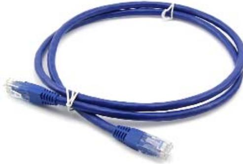
非屏蔽水晶头压接簧片  $50\ \mu\text{m}$  整体镀金，确保性能优异；采用  $7\times 0.18\text{mm}$  多股交合线屏蔽电缆，跳线柔韧性好；渐变型受力原理的加长护套，防滑抗拉，保证一定的弯曲半径。
