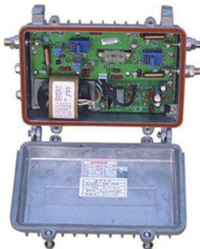
防水型延长放大器适用于作线路延长放大，用以补偿电缆之传输损耗。
