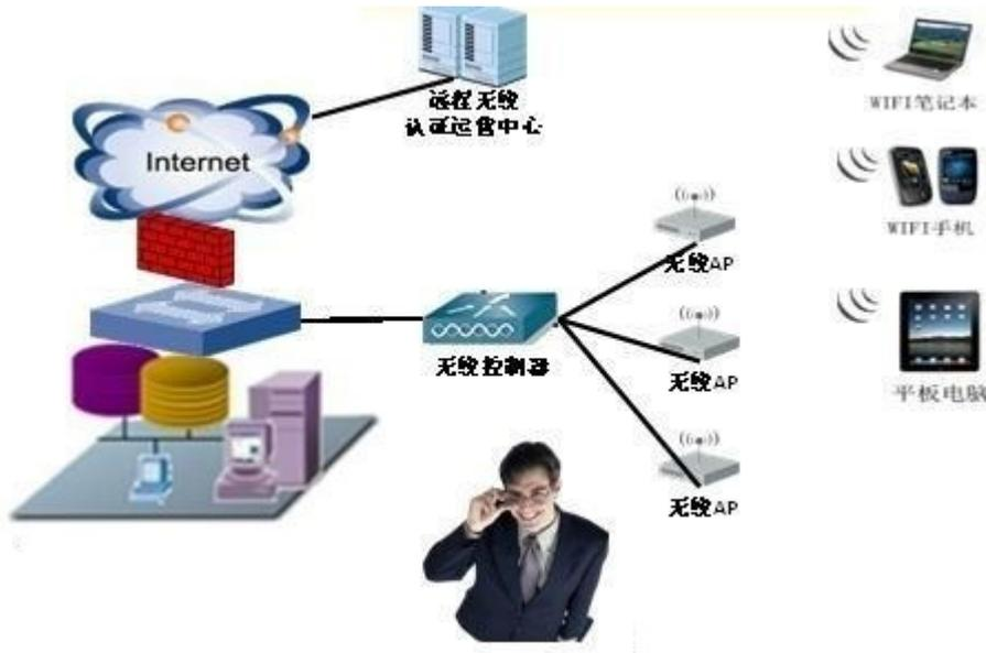
为保证多媒体数据的传输，网络技术选用千兆以太网网络技术，所有的帧格式全部选用以太网格式，主干为千兆 4 芯多模光纤，水平区域主要为非屏蔽双绞线到前端点位。
