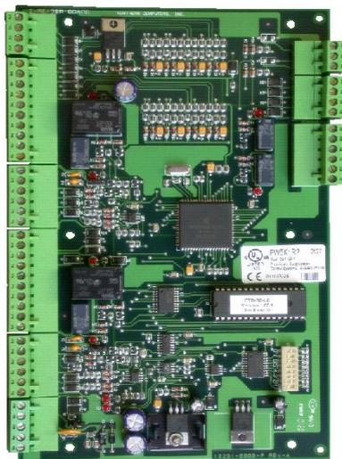
PW3K 双读卡器模块可通过与韦根或时钟/数据信号类型的读卡器、受监控的输入装置以及继电器输出装置的连接支持 2 道单向刷卡的门。用户可将双读卡器接口模块安装在插槽式机箱中，也可平铺安装。如果采用插槽式安装，则仅有一侧的端口能够接线；如果采用平铺式安装可多两个附加继电器输出端和两个附加通用报警输入端供使用，同时在与插槽式安装接线侧的相对的一侧还可提供专用于机箱防拆和电源故障检测的两个报警输入端，但同一个机箱中可以放置的双读卡器接口模块的数量相比插槽式安装要少。
